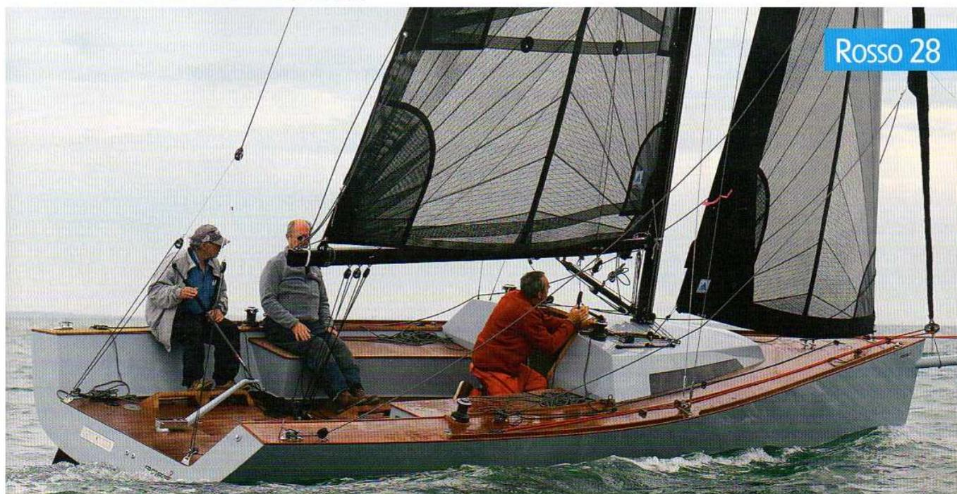
▲ Le cockpit est divisé en deux zones bien distinctes. Sur l'arrière, celle réservée au barreur qui dispose à portée de main de l'écoute de GV et du réglage du chariot de barre d'écoute. Sur l'avant, les bancs pour les équipiers, parfaits pour trois. Notez, sur le rouf, les winches dévolus aux écoutes de génois.
