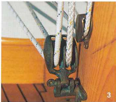
1) L'écoute de grand voile revient sur un taquet-coinceur fixé dans l'axe du bateau sur la face arrière de l'hiloire de cockpit. 2) Le réglage des voiles d'avant est facilité par deux winches à coinceur, qui permettent de border tout en gardant une main sur la barre. 3) Grâce à des poulies doubles en pied de mât, les drisses des voiles d'avant sont renvoyées vers des taquets fixés sur le rouf. 4) Pour bien supporter les efforts de traction, la barre d'écoute de grand voile est solidaire de la quille grâce à des tirants.
