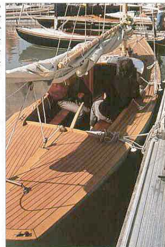
L'accastillage est entièrement en bronze et des équipets sont aménagés sous les bancs du cockpit.
