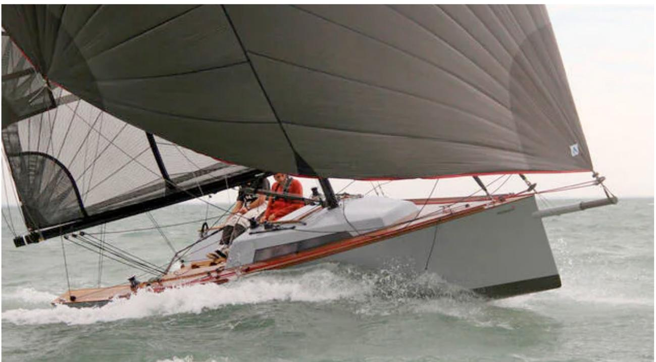
*Le Rosso 28 d'Alexandre Genoud est un habitable très vivant réalisé en strip-planking. PHOTO @ CHANTIER NAVAL DES ILEAUX*
