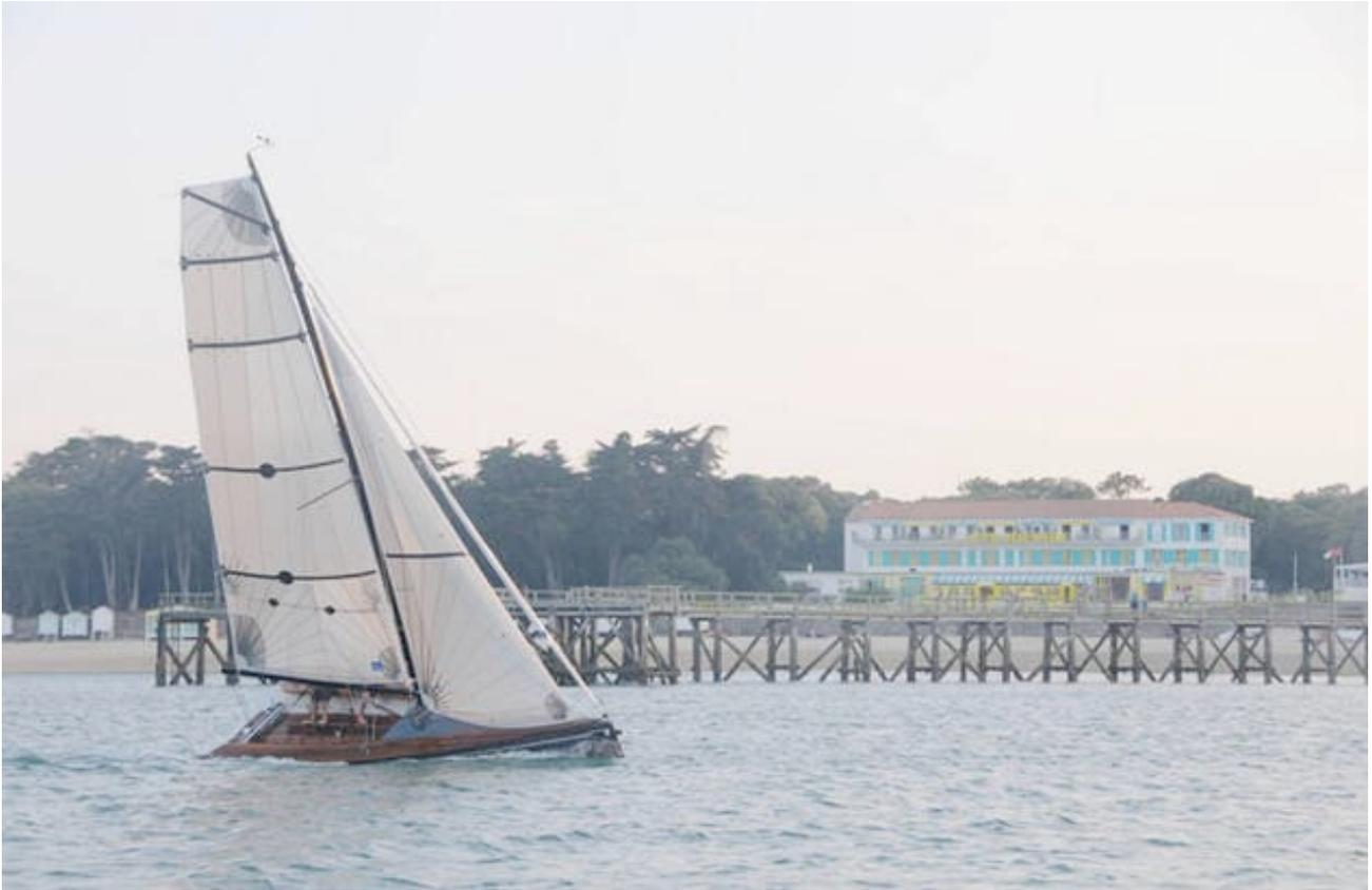
*Le Super Leggero est un voilier rapide de 6,50 mètres pour la balade à la journée dessiné par l'Italien Paolo Bua et construit en strip-planking. | PHOTO @ CHANTIER NAVAL DES ILEAUX*
