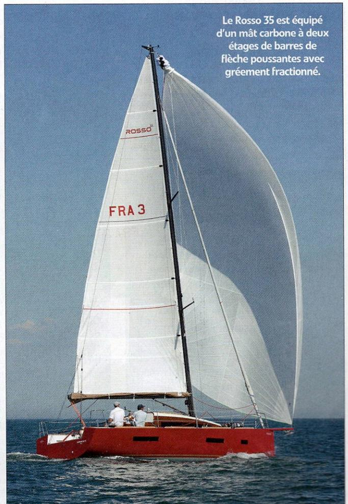
Le Rosso 35 est équipé d'un mât carbone à deux étages de barres de flèche poussantes avec gréement fractionné.
